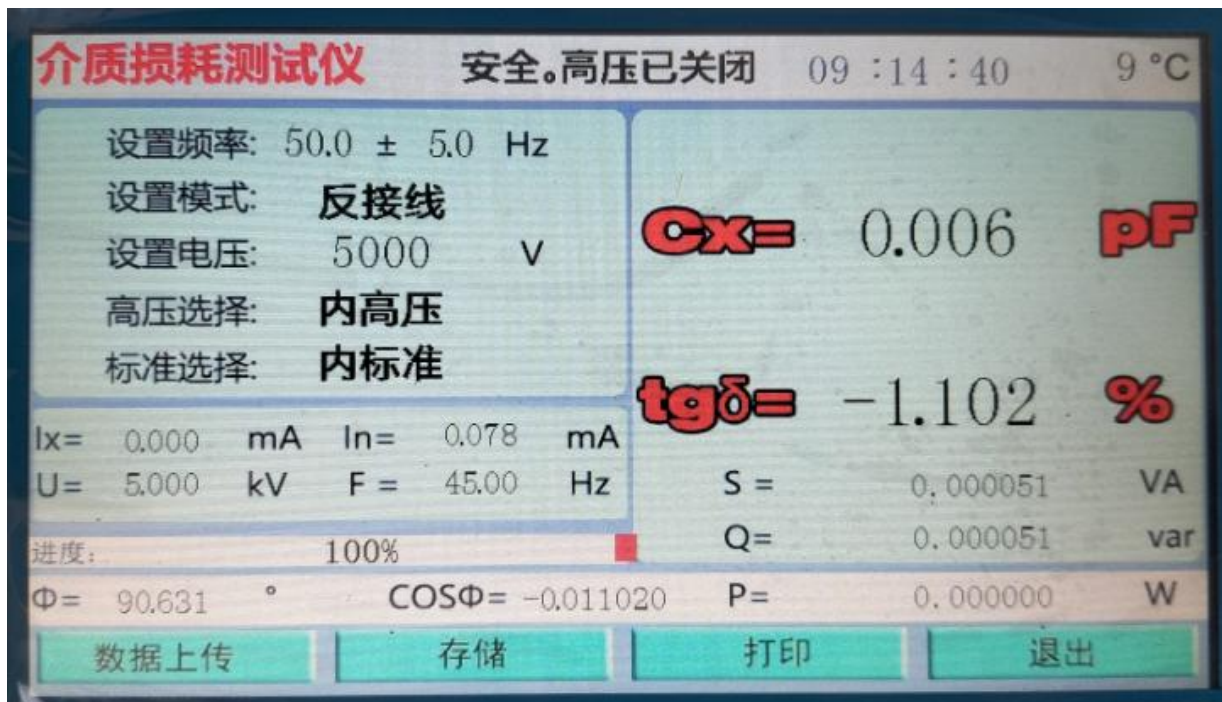
图十 反接线测试结果
